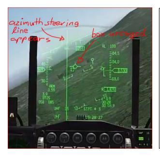
Nun kann man entweder den Pickel Button drücken oder aber auch TMS UP und die Box bleibt auf diesem Ziel liegen – löst sich (uncages) also vom FPM! Gleichzeitig erscheint die aus CCRP bekannte "azimuth steering line", die die Richtung zum gewählten Ziel vorgibt.
