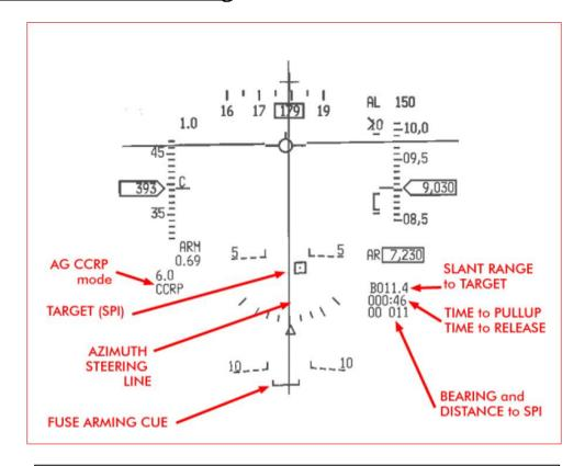
CCRP gibt im HUD sowohl horizontale Steuerung als auch Distanz Informationen zum selektierten Ziel. Man legt einfach den FPM auf die "Bomb fall steering line", hier richtiger die sogenannte "azimuth steering line" (denn die Linie bewegt sich hier anders als beim CCIP Verfahren und führt uns direkt zum Ziel.
