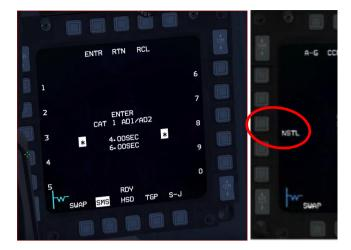
Für "normale" Eisenbomben erhalten wir die Einstellmöglichkeit für das Arming delay des NOSE und des Tail Zünders
