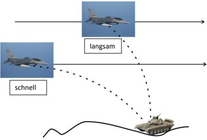
Auch wenn vielleicht übertrieben dargestellt, so soll hier gezeigt werden, dass der Zeitpunkt des Abwurfs sehr stark von der Geschwindigkeit und Höhe der F-16 abhängt, dies aber vom FCC entsprechend einberechnet wird, wenn diese nahezu konstant bleiben oder sich (langsam) kontinuierlich ändern (geringe aber fortlaufende Änderungen in Speed und Höhe sind ok)! Aber:
