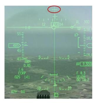
Dieser Balken läuft insgesamt **zwei Mal** die Steuerlinie hinunter bis zum Horizontalbalken des FPM. Beim ersten Mal erscheint dann die sogenannte **loft cue**. Für die Spezialisten unter Euch: Es gibt zwei Arten Bomben via CCRP ins Ziel zu bringen. Mittels LOFT oder mittels "direct pickle".
