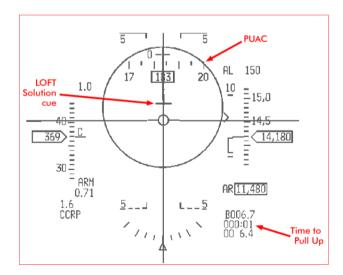
Kommen wir dem Ziel näher, ändert sich das Aussehen des HUD und eine horizontale Line erscheint am oberen Rand der "azimuth steering line". Sie beginnt in Richtung des FPM zu sinken. Dies ist der "LOFT Solution cue".
