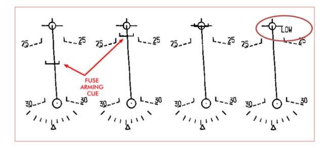
Das «FUSE ARMING CUE» geht sozusagen Hand in Hand mit dem eingestellten Arming Delay der verwendeten Bombe, aber natürlich auch mit der erflogenen Abwurfhöhe. Es markiert schlicht und ergreifend, ob die Bombe vor Auftreffen auf dem anvisierten Ziel noch scharf wird oder als «DUD» auf den Boden fällt und kaum Schaden anrichtet.
