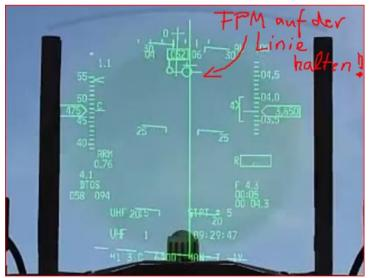
Während des pull up nähert sich der 2. release cue bereits dem FPM. Wichtig ist, den FPM so genau als möglich auf der command steering line zu halten. Wenn alles richtig läuft erreicht der 2. release cue genau bei dem Release Angle (RA) den FPM und die Bombe wird abgeworfen.
